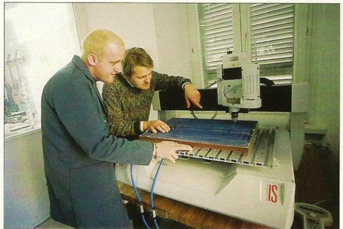
Alles automatisch: Ein Automat schneidet das Grundelement des Tonabnehmers aus der Baumwollfaserplatte
